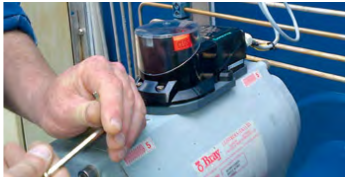
Der F31K2 lässt sich ganz einfach am pneumatischen Antrieb montieren. Der Sensor wird direkt am Antriebsgehäuse angebracht, und der Betätiger muss lediglich auf der Antriebswelle montiert und je nach Ventilstellung arretiert werden.
