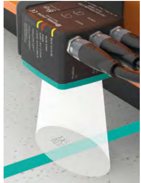
Das einzigartige Positioniersystem Position Guided Vision kombiniert erstmals zwei Technologien in einem Gerät: Farbbandverfolgung zur optischen Spurführung und Data Matrix Codes zur exakten Positionierung von fahrerlosen Transportsystemen.
