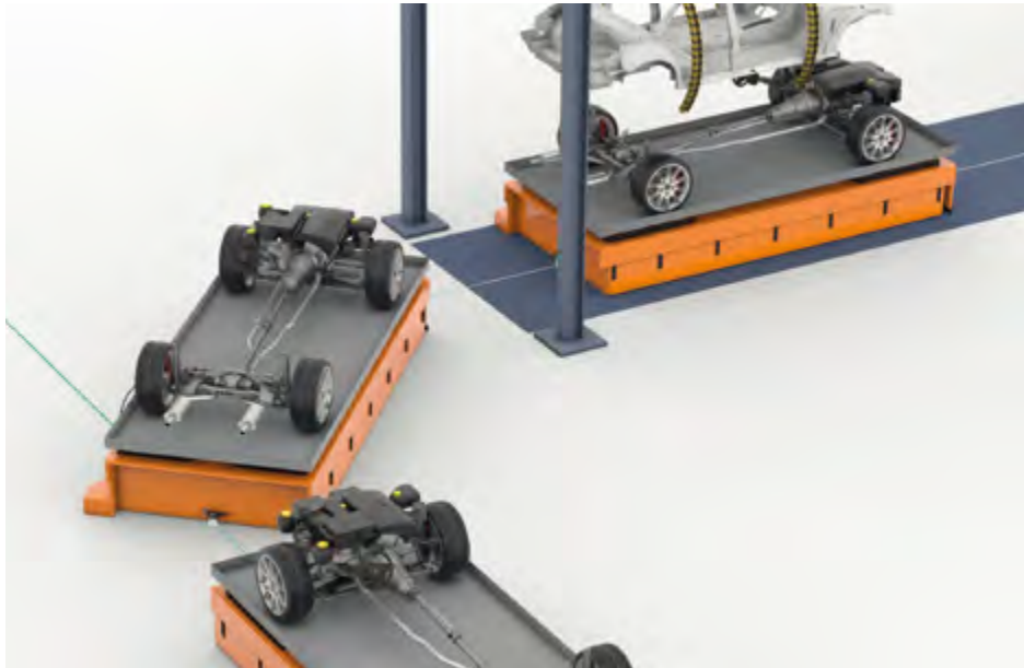
Das einzigartige Positioniersystem Position Guided Vision kombiniert erstmals zwei Technologien in einem Gerät: Farbbandverfolgung zur optischen Spurführung und Data Matrix Codes zur exakten Positionierung von fahrerlosen Transportsystemen.
