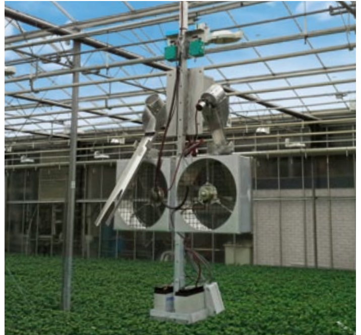
An beiden Seiten der hängenden Apparatur angebracht, bieten Ultraschallsensoren zuverlässigen Kollisionsschutz im Gewächshaus.
