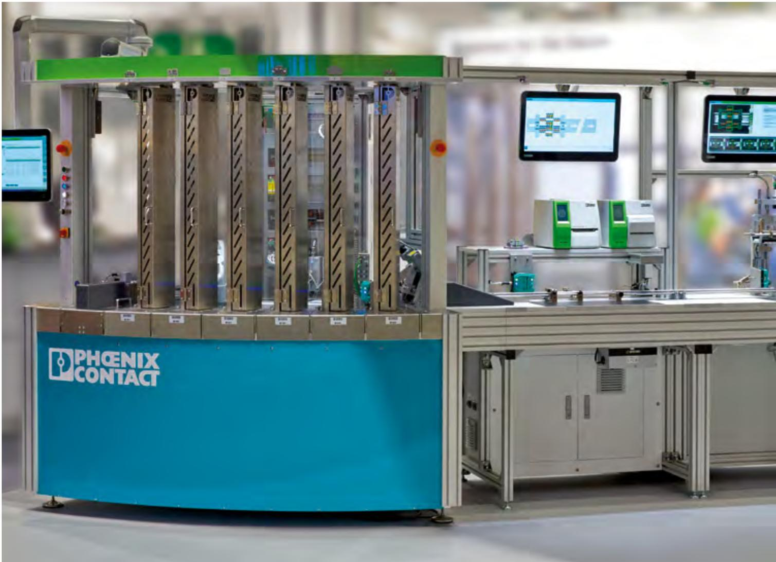
Die ClipX-Maschine erlaubt die automatisierte Herstellung von bestückten Tragschienen in der Losgröße eins. Die Auftragsdaten werden mit der digitalen Projektierungsinformation gekoppelt und an das Steuerungssystem der Maschine übermittelt. Der UHF-Schreib-/Lesekopf F190 von Pepperl+Fuchs stellt die entscheidende Verbindung zwischen den Komponenten und der Maschine her.
