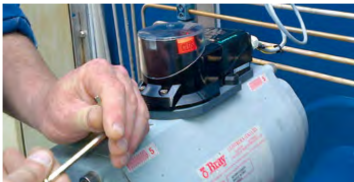
De F31K2 kan eenvoudig rechtstreeks op het pneumatische actuator worden gemonteerd. De sensor is rechtstreeks verbonden met de behuizing van de aandrijving en de puck hoeft alleen maar op de aandrijfas te worden bevestigd in overeenstemming met de huidige klepstand.
