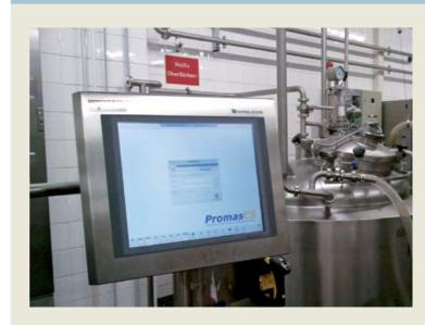
**UNTERSTÜTZUNG FÜR ANWENDER:** Die Bedienstationen helfen bei Rezepturabarbeitung und Wägevorgängen – Fehler können so minimiert werden.
