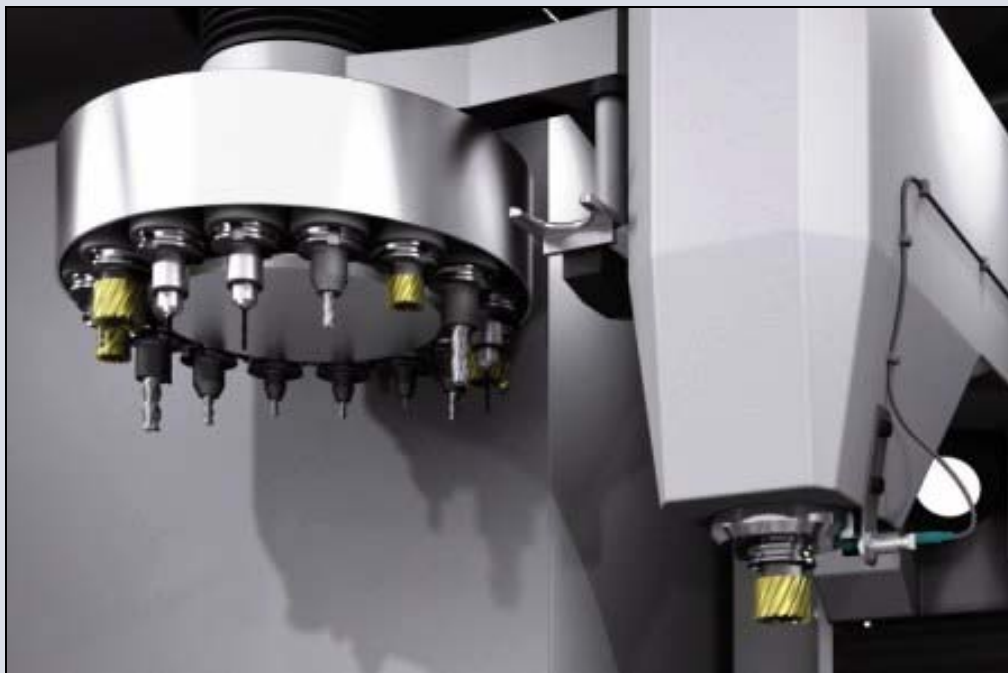
Sichere Auswahl des richtigen Werkzeugs mit RFID
