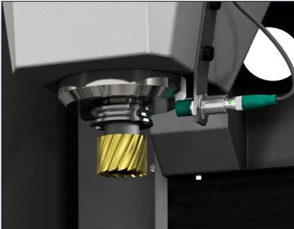
Bohrkopfüberwachung mit RFID
