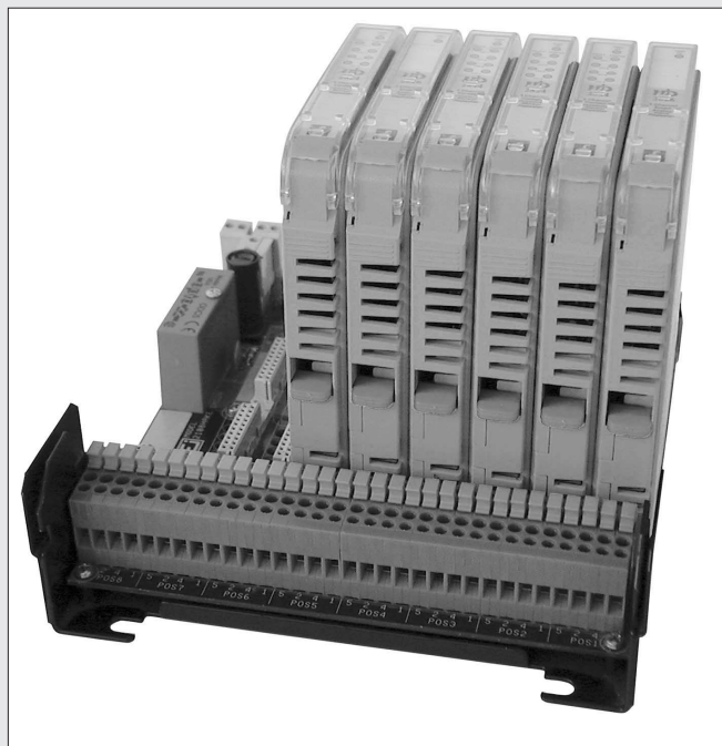
Abb.3: HiD2000-Motherboard mit Messer-Trennklemmen: ideal zur Inbetriebnahme und für Messungen unter Betriebsbedingungen
