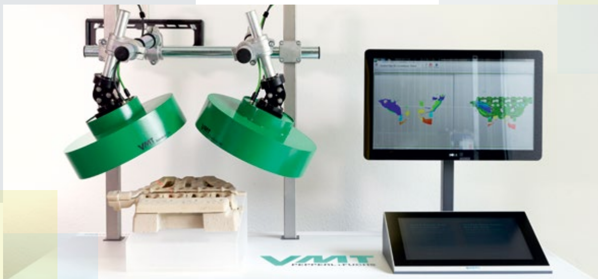
Fin nel più piccolo dettaglio: grazie ai movimenti rotatori del sistema SpinScan3D, quattro sensori perfettamente coordinati creano un'immagine dettagliata del campione di sabbia e, da questa, i dati per lo stampo di fusione.
