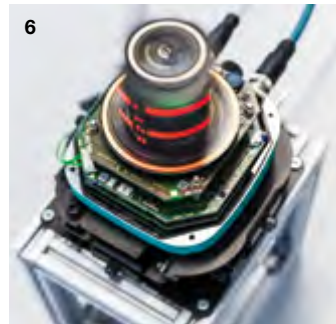
Lewa strona: 1) Maszyna do produkcji automatycznej montująca kurtynę świetlną 2) Czujnik odległości VDM28 w zautomatyzowanym stanowisku testowym Prawa strona: 3) Końcowy montaż czujnika fotoelektrycznego 4) Testy mechaniczne wielowiązkowego skanera LED R2100 5) Innowacyjna koncepcja montażu czujników fotoelektrycznych 6) Kontrola działania wyświetlacza 360° skanera laserowego 2D R2000
