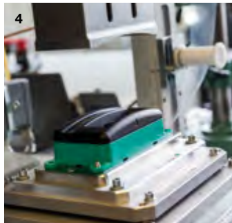
Lewa strona: 1) Maszyna do produkcji automatycznej montująca kurtynę świetlną 2) Czujnik odległości VDM28 w zautomatyzowanym stanowisku testowym Prawa strona: 3) Końcowy montaż czujnika fotoelektrycznego 4) Testy mechaniczne wielowiązkowego skanera LED R2100 5) Innowacyjna koncepcja montażu czujników fotoelektrycznych 6) Kontrola działania wyświetlacza 360° skanera laserowego 2D R2000
