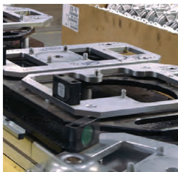
■ 包装机械使用编码器测量目标物长度，计算包装膜数量。
