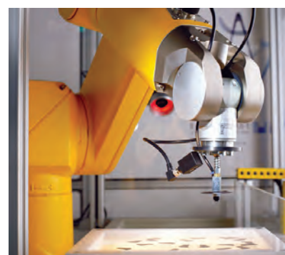
■ 机器人使用编码器监测工具位置和驱动轴移动
