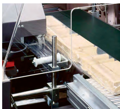
■ 输送带使用编码器监测速度和物体在输送带上移动距离
